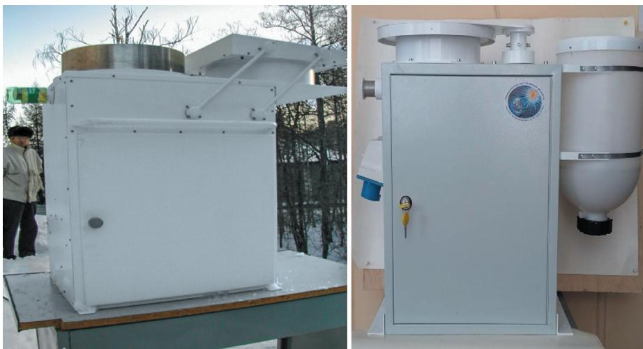
Рис. 3. Внешний вид автоматических осадкоизмерителей: для эксплуатации при низкой температуре (а), двухпозиционный (б).
