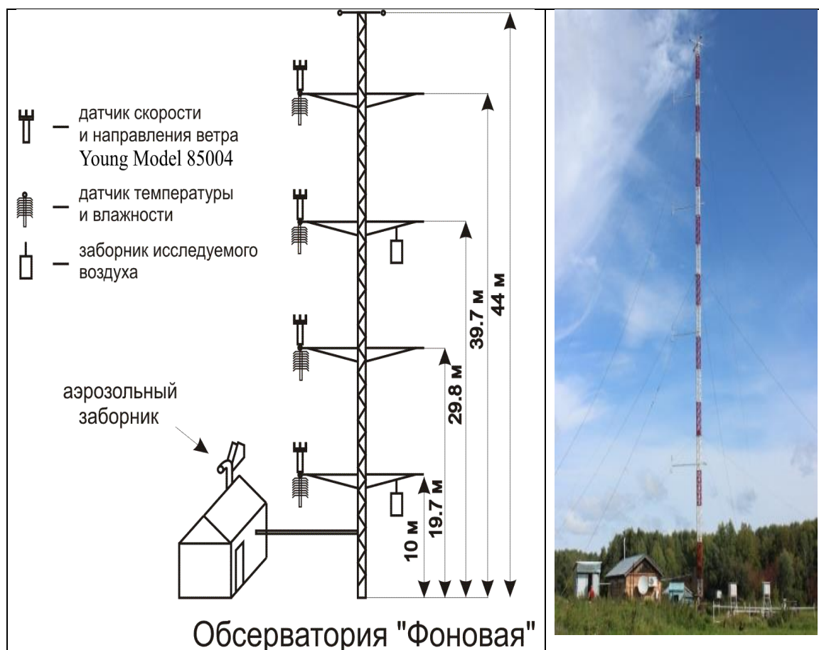
Рис. 2. Изображение мачты и аппаратного помещения Обсерватории «Фоновая» Fig. 2. Image of the mast and the hardware room of the Observatory "Fonovaya"
