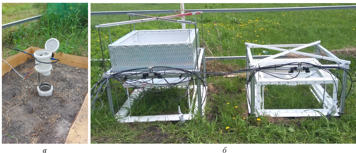
Рис. 1. Внешний вид: малогабаритной прозрачной камеры, установленной на участке без растительности (б); темной и прозрачной камер на участке с растительностью (а)
